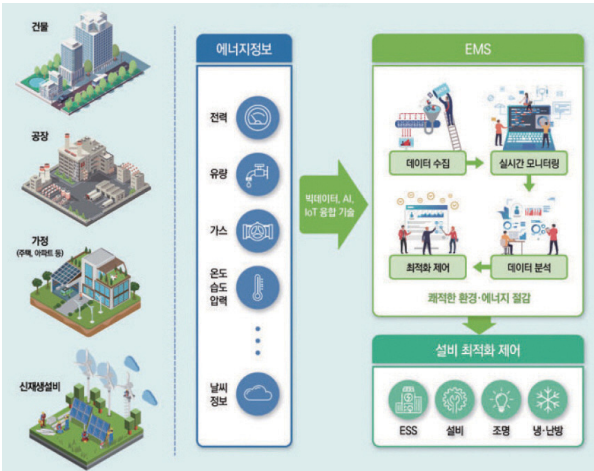
▮ 그림 56 ▮ 건물에너지이용 최적제어 통합관리시스템(BEMS) 개념도
