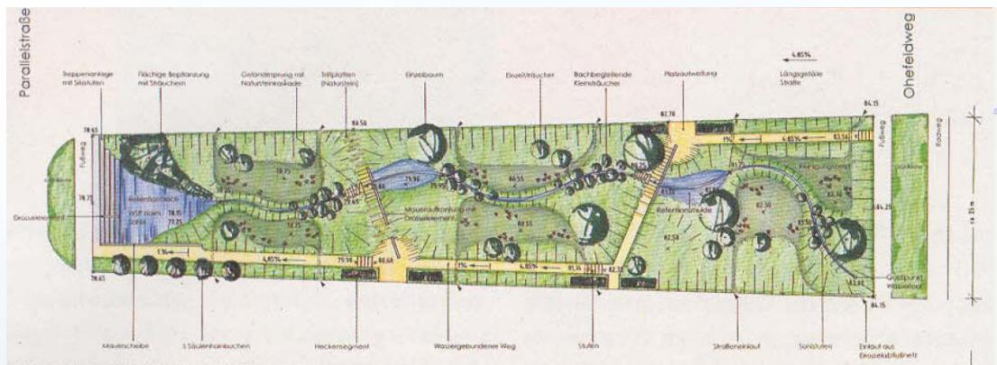
그림 13. 도로 가운데 우수의 침투 및 유입을 통해 저류가 되도록 조성되어 있는 Hillside 거리의 물순환체계 시스템(출처: Hannover, 2000, p.23)
