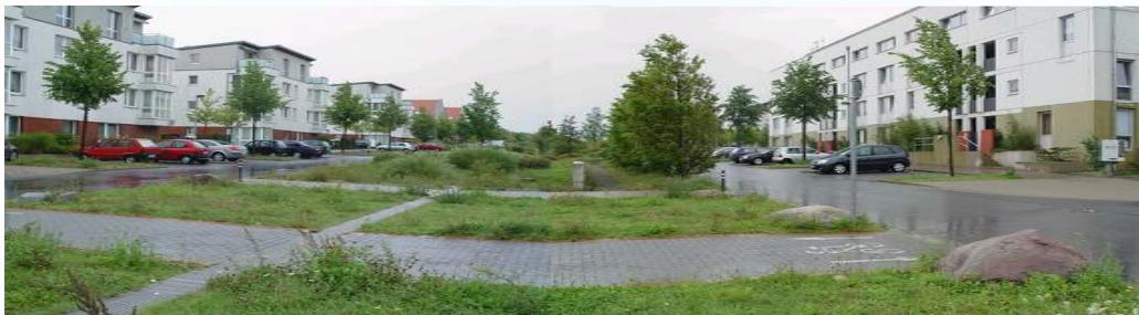
그림 16. 자동차 도로 사이에 조성된 녹지축이자 우수의 침투가 가능한 자연배수시스템
