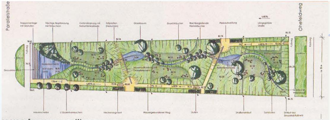
그림 13. 도로 가운데 우수의 침투 및 유입을 통해 저류가 되도록 구성되어 있는 Hillside 거리의 물순환체계 시스템(출처: Hannover, 2000, p.23)
