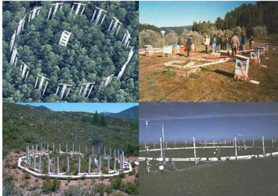
<그림 12>FACE(Free Air Concentration Enrichment) Experiment
